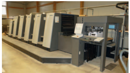
Auch im Offsetbereich hat sich aktuell bei Schmekies etwas getan. Die mit dem Umzug 2014 ins neue Gebäude eingebrachte Heidelberg XL 75-5 + L wird jetzt mit Druckplatten vom nagelneuen Heidelberg Suprasetter A 75 versorgt.
